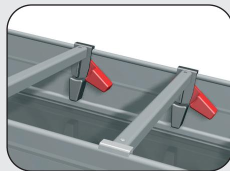
Spessori guida necessari per recuperare le varie differenze di spessore delle spalle laterali del mobile.
